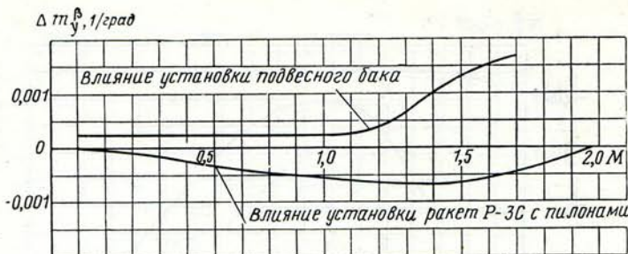
Рис. 152. Изменение коэффициента путевой статической устойчивости самолета при установке подвешного бака и ракет Р-3С с пилонами
