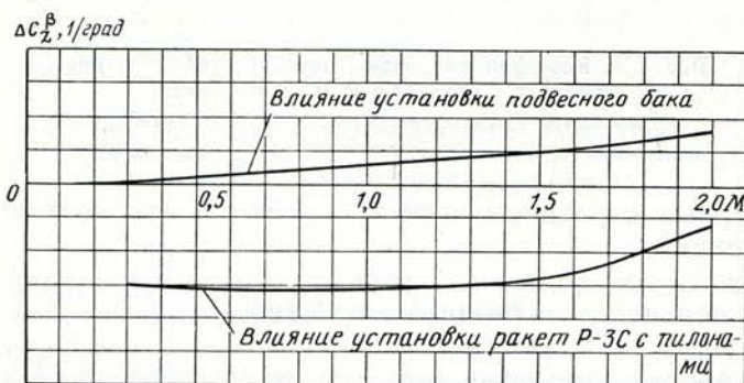
Рис. 147. Изменение коэффициента боковой силы самолета от установки ракет Р-3С с пилонами и установки подвесного топливного бака
